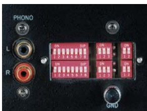
Phono mit einstellbarer Empfindlichkeit, MC-low (ab 0,6mV), MC-high, MM, R + C-Anpassung.
